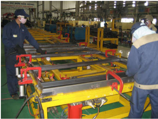
Hình 1. Khâu lắp ráp sườn khung hông
