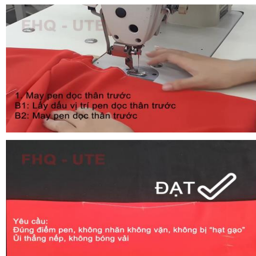
Hình 2. Yêu cầu kỹ thuật và các bước may pen dọc thân trước
