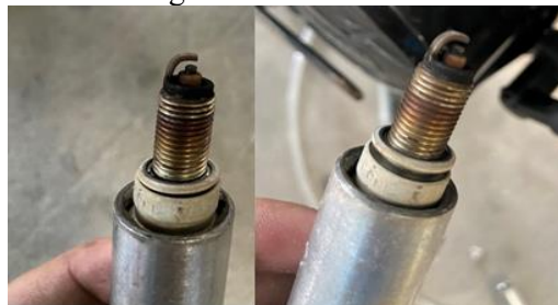
Hình 8. Màu sắc bugi trước và sau khi thử nghiệm
