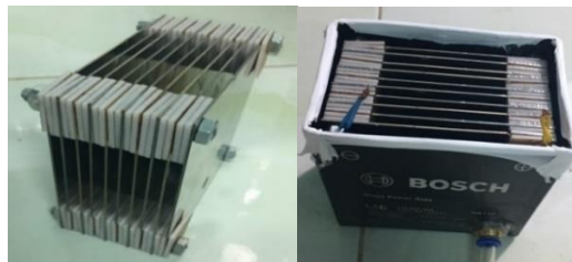
Hình 2. Bộ điện phân sau khi gia công
