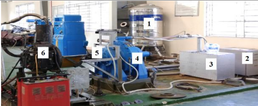
Hình 5. Động cơ được đưa lên bệ thử tại phòng thí nghiệm (1. Téc nước, 2. Tủ điều khiển, 3. Bơm nước, 4. Phanh thủy lực, 5. Các đăng, 6. Động cơ)
