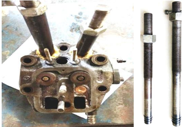
Hình 4. Nắp máy được gắn hai piston phụ để thay thế tích buồng cháy phụ (trái) và hai piston phụ (phải).
