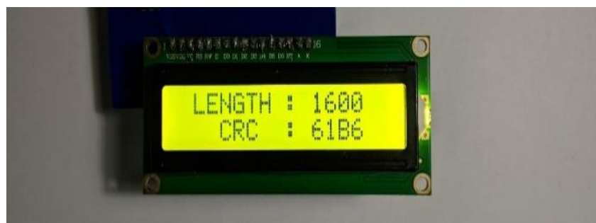
Hình 12. Kết quả tính toán CRC của bộ mã hóa với block dữ liệu dài 1600 bit.
