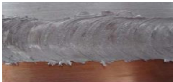
Hình 4. Tấm bimetal Cu/Al được chế tạo xong
