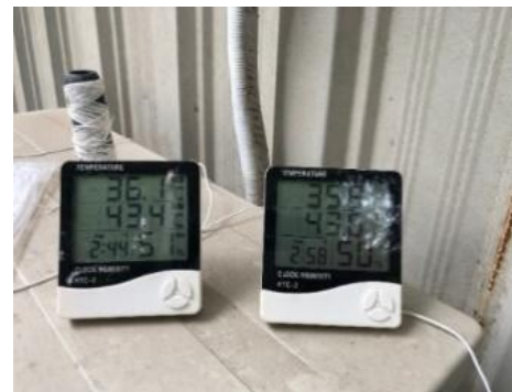
Hình 9. Nhiệt độ không khí trước và sau khi đi qua mô hình thiết bị giải nhiệt.
