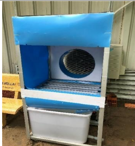
Hình 7. Mô hình thực tế sau khi được gia cố lại các khe hở vách ngăn.
