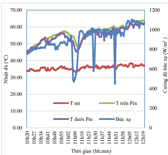
Hình 11. Nhiệt độ của tấm PV + nước
