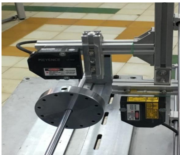
Hình 8. Bố trí lắp đặt Sensor LK_G35
