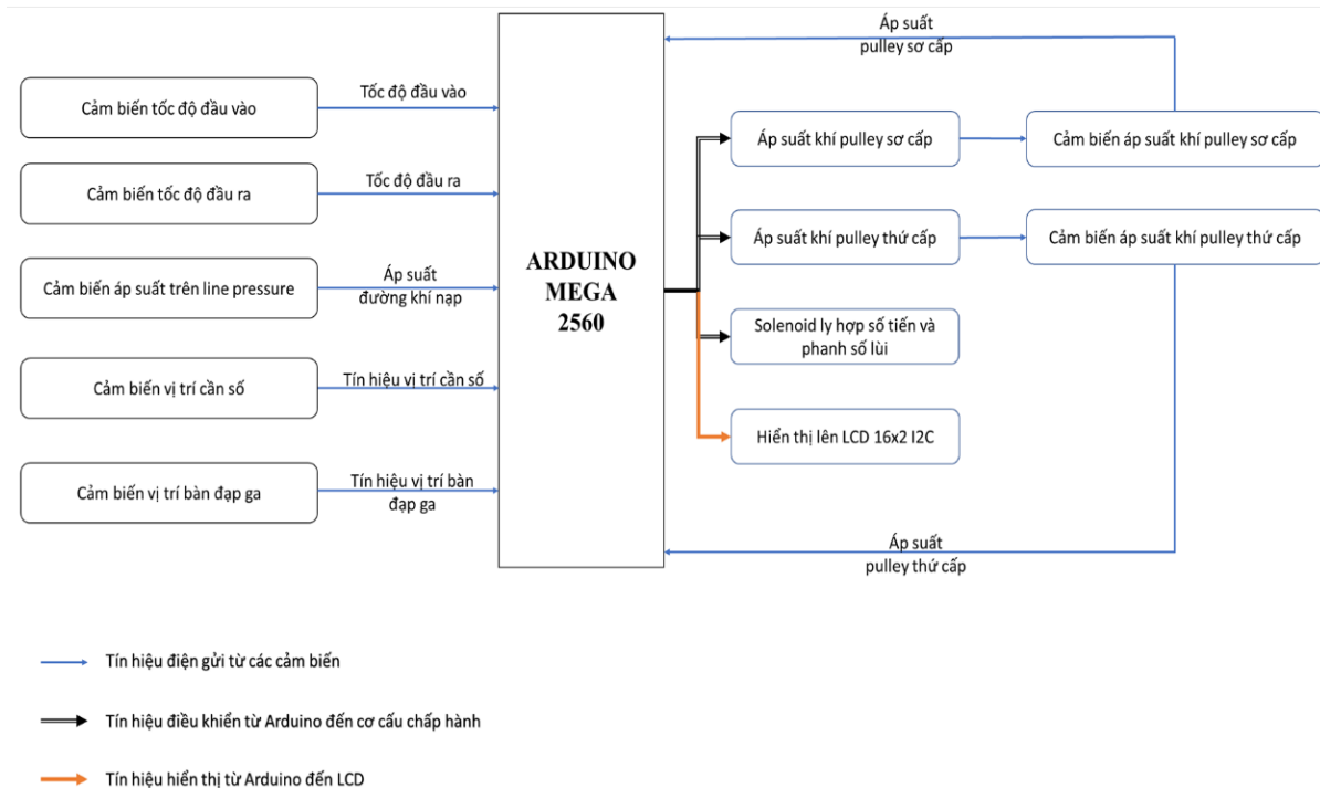
Hình 6. Lập sơ đồ điều khiển của hệ thống điều khiển CVT bằng khí nén
