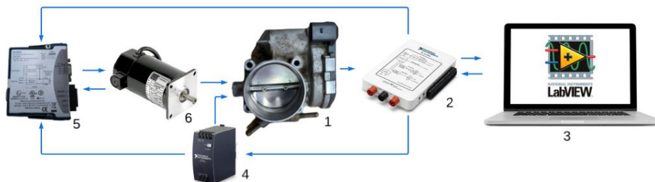
Hình 4. Sơ đồ khối hệ thống thu thập dữ liệu
