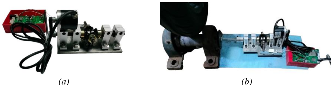
Hình 9. (a) Hệ thống đo mô-men của động cơ và (b) hệ thống khi lắp đặt tại vị trí bánh xe sau.
