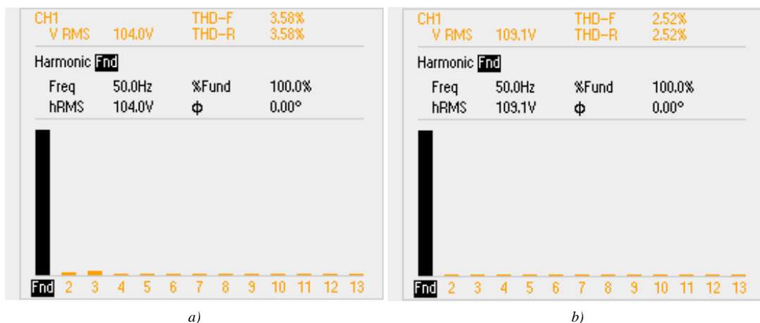
Hình 8. Kết quả thử nghiệm THD đầu ra của bộ IP-BBqZS-CGI. a) Với điện áp đầu vào 100-V, b) Với điện áp đầu vào 200-V.
