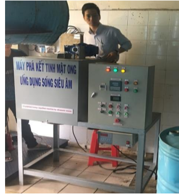
Hình 6. Máy phá kết tinh mật ong ứng dụng sóng siêu âm được tính toán và chế tạo hoàn chỉnh
