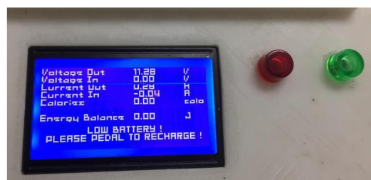
Hình 7. Màn hình hiển thị thông báo năng lượng đang ở mức thấp.
