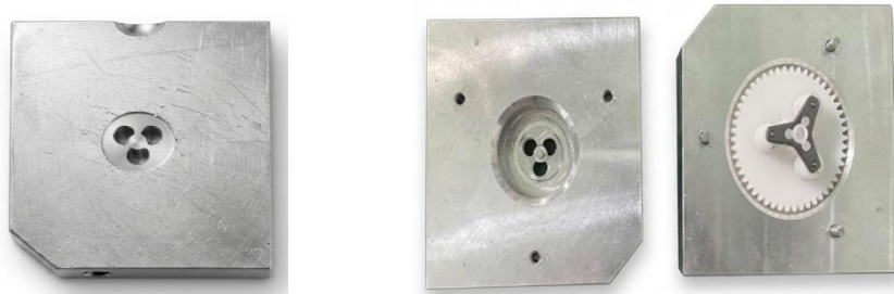
Hình 4. Thiết kế bộ đồ gá hỗ trợ lắp ráp final gear.
