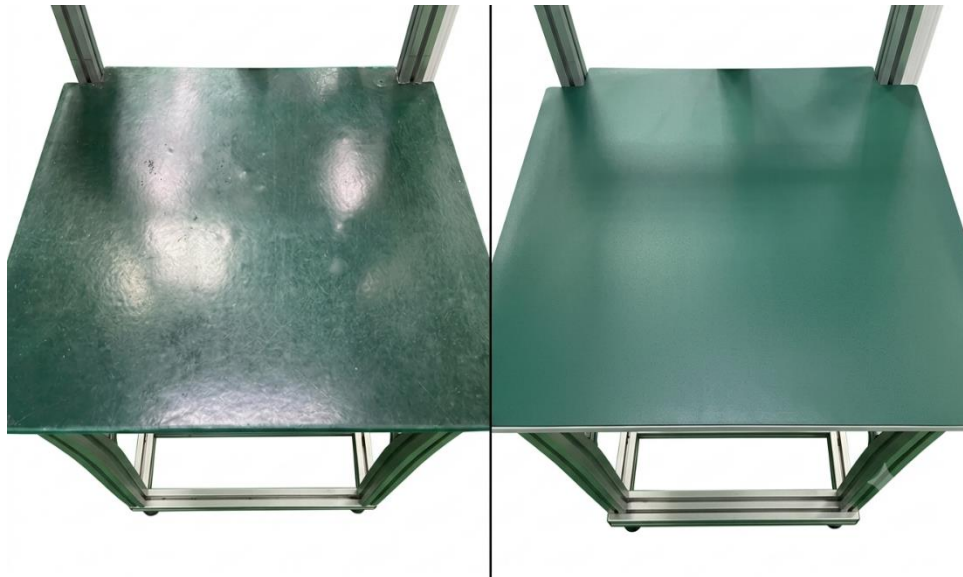
Hình 6. Mặt bàn trước và sau khi trải tấm ESD.
