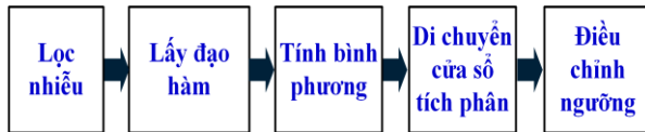
Hình 5. Sơ đồ khối của thuật toán Pan-Tompkins được sử dụng cho phát hiện phức bộ QRS.
