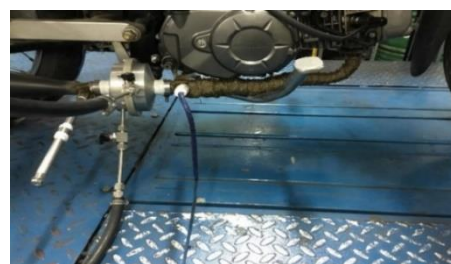
Hình 7. Bộ xúc tác được gắn trên động cơ xe gắn máy
