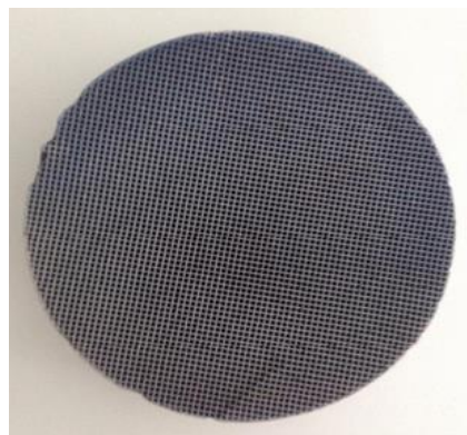
Hình 5. Chất xúc tác Ni/Monolith sau khi nung (kích thước 9,0 x 2,5 cm)
