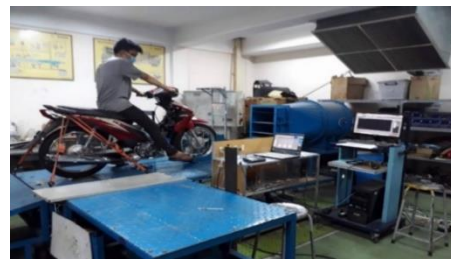
Hình 6. Thử nghiệm với bộ xúc tác xử lý khí thải
