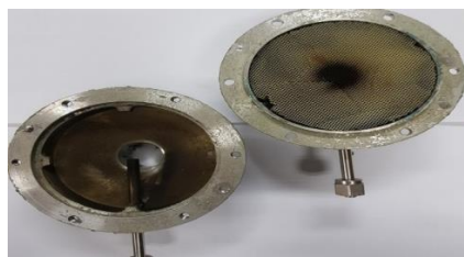
Hình 8. Bộ xúc tác chuyển đổi sau khi thử nghiệm
