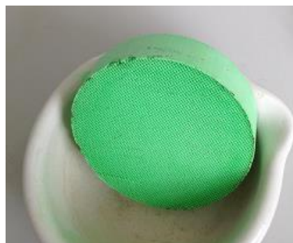
Hình 4. Chất xúc tác Ni/Monolith sau khi tẩm ướt (kích thước 9,0 x 2,5 cm)
