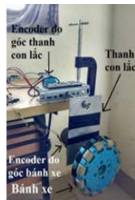
Hình 2. Mô hình con lắc bánh xe quán tính
