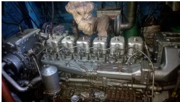
Hình 2. Động cơ Mitsubishi-6AAC-1 trên tàu
