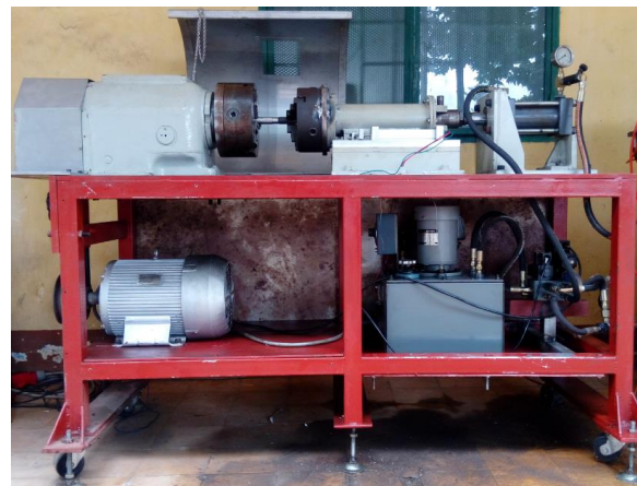
Hình 4. Máy hàn ma sát xoay (REME Lab)
