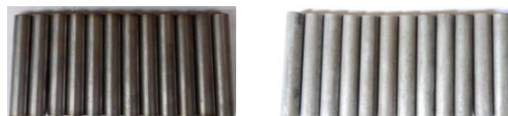
a) 12 mẫu chi tiết thép AISI 304 b) 12 mẫu chi tiết thép AISI 1020
