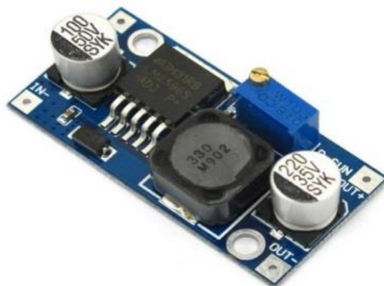
Hình 13. Mạch giảm áp LM2596
