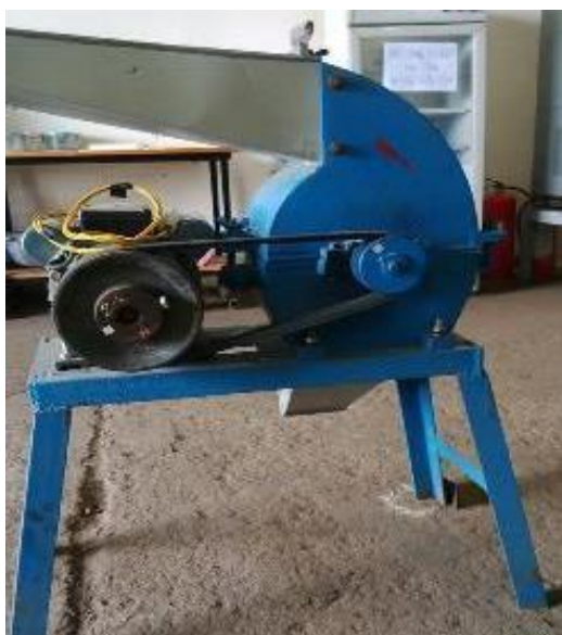
Hình 3. Máy nghiền bã hèm bia được chế tạo hoàn chỉnh
