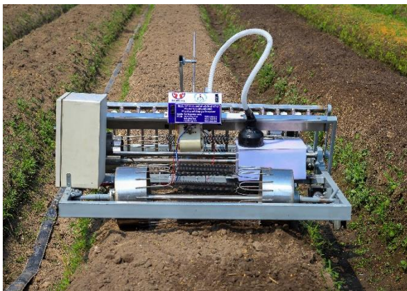
Hình 15. Máy gieo hạt điều khiển bằng giọng nói thông qua smart phone
