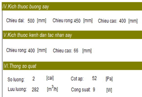
Hình 20. Kết quả kích thước buồng sấy, kênh dẫn tác nhân sấy và thông số quạt
