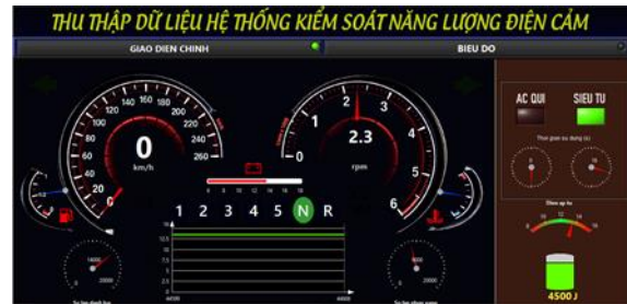
Hình 12. Giao diện thu thập dữ liệu hệ thống kiểm soát năng lượng điện cảm trên LabVIEW
