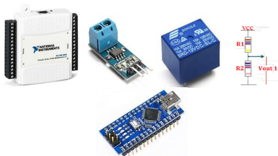
Hình 2. Trang thiết bị sử dụng trong thu thập tín hiệu và điều khiển
