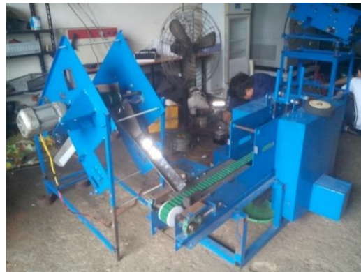
Hình 5. Máy tách cuống ớt bán tự động đã được chế tạo và lắp ráp hoàn chỉnh.
