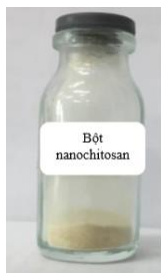
Hình 1. Bột nanochitosan sau phản ứng được sấy ở 55°C trong 24h
