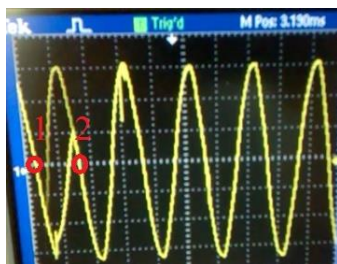
Điểm 1: Ngắt pha A Điểm 2: Đóng pha B
