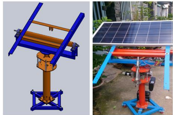
Hình 7. Hệ tracking hoàn thành thực tế
