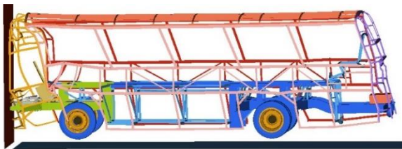
Hình 5. Kết cấu đầu xe sau cải tiến
