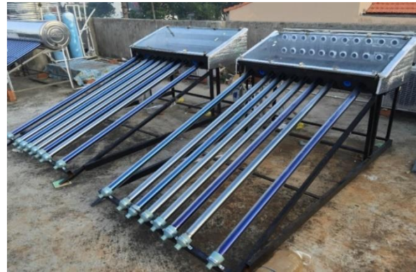
Hình 2. Thực nghiệm song song 2 thiết bị chung cất nước sử dụng NLMT dạng Single Basin kết hợp 8 OTTCK có và không sử dụng BNTN
