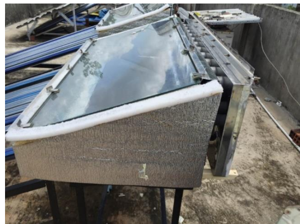
Hình 3. Bộ ngưng tụ ngoài được lắp đặt ngay phía sau bể chung cất
