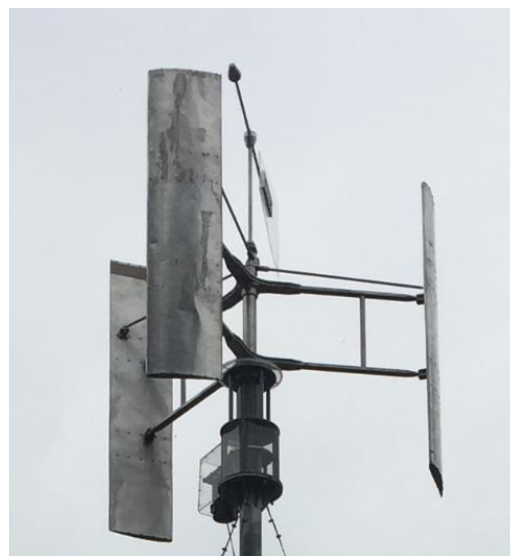
Hình 10. Tuabin gió tự điều chỉnh cánh đã chế tạo
