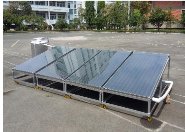
Hình 2. Sơ đồ thực tế bộ thu năng lượng mặt trời
