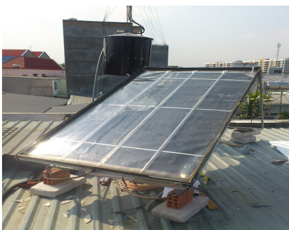
Hình 6. Thực nghiệm tấm chung cất nước Carocell
