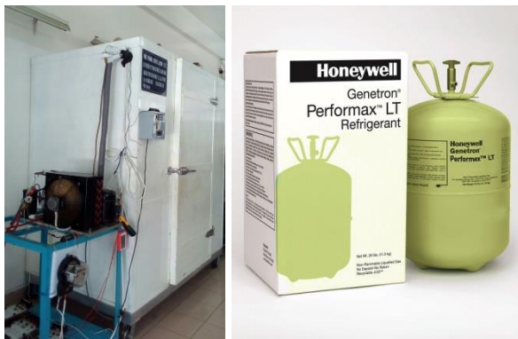
Hình 1. Mô hình kho lạnh và môi chất lạnh R407F được sử dụng trong thí nghiệm
