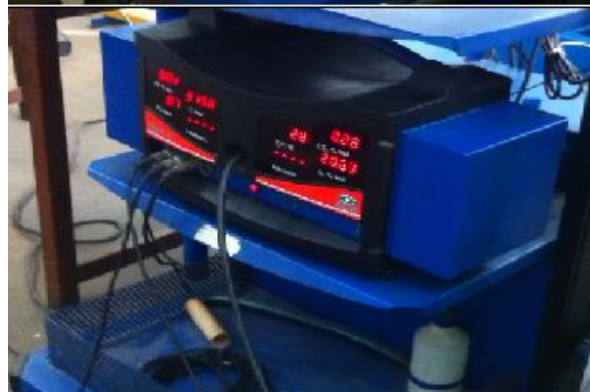
Hình 8. Màn hình hiển thị và thiết bị đo khí thải Maha MGT5.
