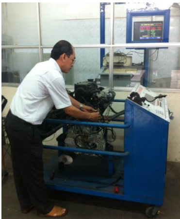
Hình 10. Kết nối động cơ thiết bị đo tiêu hao nhiên liệu Maha LPS 2000.
