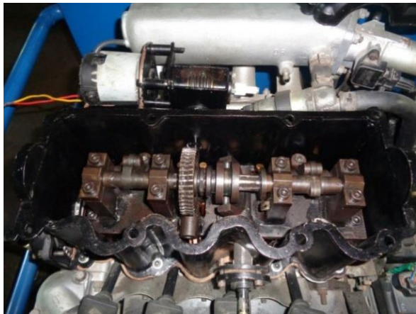
Hình 7. Cơ cấu điều khiển lắp trên động cơ Hyundai
