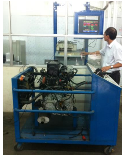
Hình 11. Quá trình thử nghiệm xác định lượng nhiên liệu tiêu hao.
