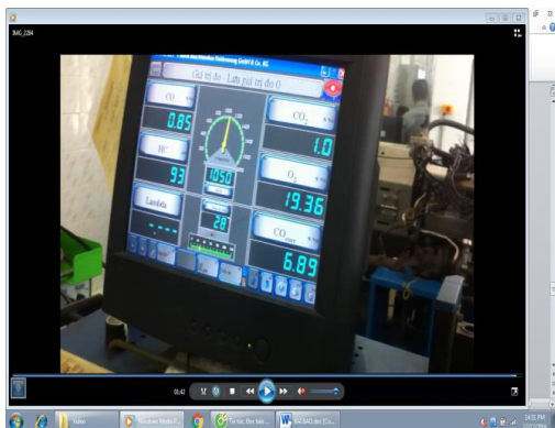
Hình 15. Kết quả thử nghiệm nồng độ khí thải CO.
