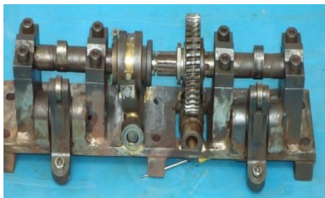
Hình 4. Cụm cơ cấu điều khiển ngắt xi lanh.
