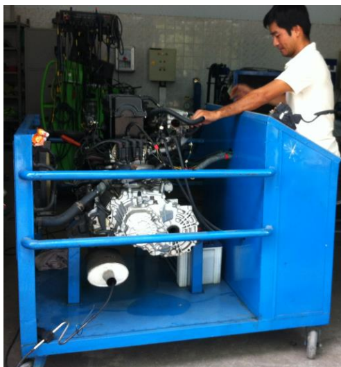
Hình 14. Quá trình thử nghiệm đo khí thải động cơ.
