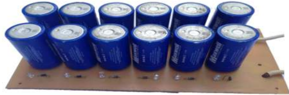
Hình 12: Thiết bị lưu trữ năng lượng gồm 12 siêu tụ Maxwell BCAP0350
