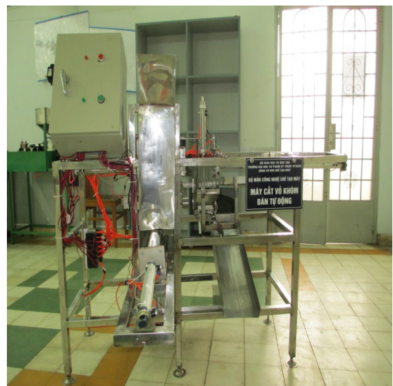
Hình 17: Máy gọt vỏ, lấy cùi thơm bán tự động.
