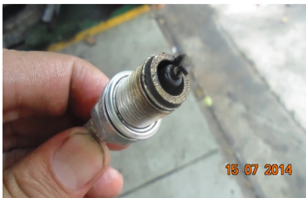
Hình 3.4. Muội than sau khi sử dụng thiết bị và nhiên liệu súc rửa nghiên cứu.
