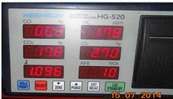
Hình 3.3. Thành phần khí thải sau khi sử dụng thiết bị và nhiên liệu súc rửa mới.
