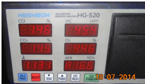
Hình 3.6. Thành phần khí thải sau khi sử dụng nhiên liệu súc rửa đã được nghiên cứu.
