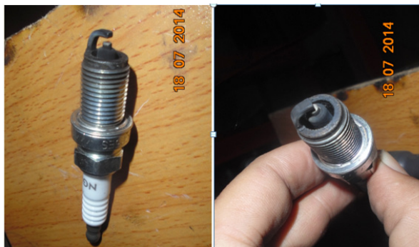
a) trước khi súc rửa b) sau khi súc rửa Hình 3.7. Muội than bám đầu bugi trước, sau khi sử dụng thiết bị và nhiên liệu súc rửa.
