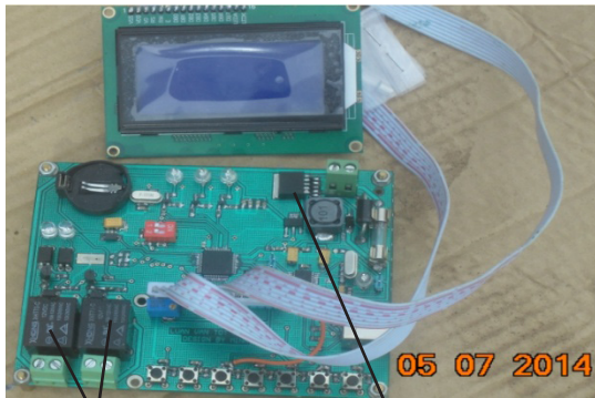
Hình 2.4. Mạch LCD thiết kế và chế tạo.
