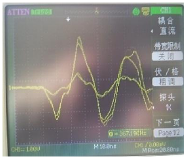
+ Xung phát ra của cảm biến tốc độ motor:
