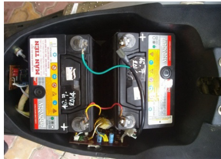
Hình 3.23: Các mạch điện và Accu sau khi lắp vào xe.
