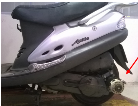
Hình 3.13: Cơ cấu truyền động của động cơ điện sau khi lắp vào xe.
