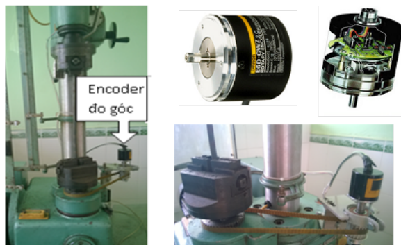
Hình 7: Gắn Encoder đo góc xoắn.
