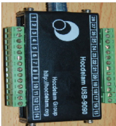
Hình 11: Mạch giao tiếp máy tính điều khiển các rơ le.
