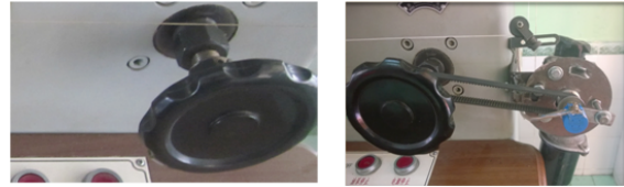
Hình 4: Sử dụng động cơ DC điều khiển quá trình thí nghiệm.
