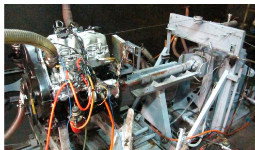
Hình 4: Mô hình tổng thể lắp đặt hệ thống cung cấp nhiên liệu Diesel VE-EDC trên động cơ thực nghiệm.
