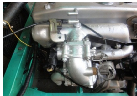
Hình 3:Thiết kế, lắp đặt các cảm biến trên động cơ Hyundai.
