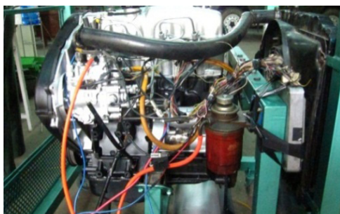
Hình 2: Hệ thống cung cấp nhiên liệu VE-EDC lắp trên động cơ Hyundai.
