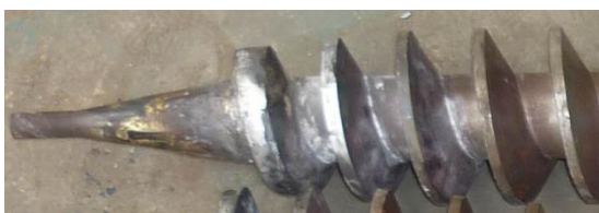
Hình 3. Trục vít ép được hàn đắp [3]
