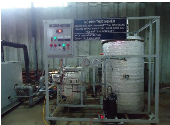
Hình 3. Mô hình thí nghiệm hệ thống bơm nhiệt đun nước nóng WTW
