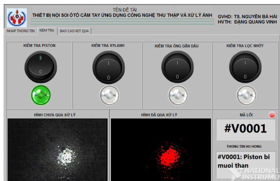
Hình 5.b: Giao diện hiển thị Piston bị đóng muội than [10] (Mã lỗi #V0001).
