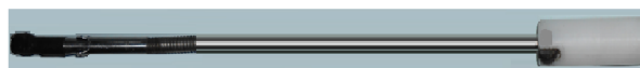
Hình 10: Thiết bị nội soi ô tô cầm tay ứng dụng công nghệ thu thập và xử lý ảnh.
