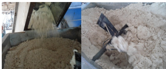
Hình 3: Bã sắn sau khi qua máy ép tách nước (độ ẩm còn 60÷65%).
