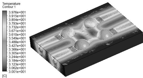
Hình 22: Kết quả mô phỏng với kiểu xem Contour sản phẩm lọc lòng đỏ trứng.
