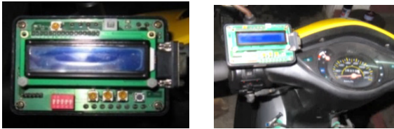
Hình 14: Board mạch hoàn thiện và lắp thử nghiệm trên xe.
