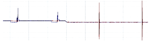
Hình 17: Dạng sóng điện áp sơ cấp của bobin tại thời điểm chuyển mạch.
