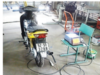
Hình 21: Thiết bị đo khí thải Horiba kết nối với đường ống thải xe gắn máy.
