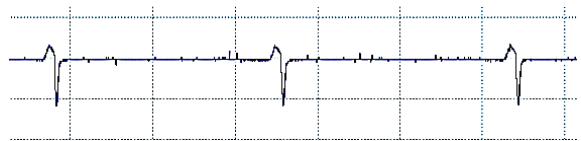
Hình 2: Tín hiệu phát ra của cảm biến vị trí trục khuỷu.
