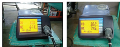
Hình 22: Thông số kết quả đo khí thải khi sử dụng kiểu đánh lửa TI-CDI và kiểu đánh lửa nguyên thủy CDI.
