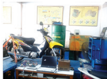
Hình 18: Xe gắn máy Honda Wave RS được lắp trên băng thử tạo tải để đo lượng nhiên liệu.
