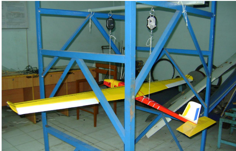
Hình 10: Cân tải và xác định vị trí trọng tâm của mô hình máy bay lượn sải cánh 1.8 m
