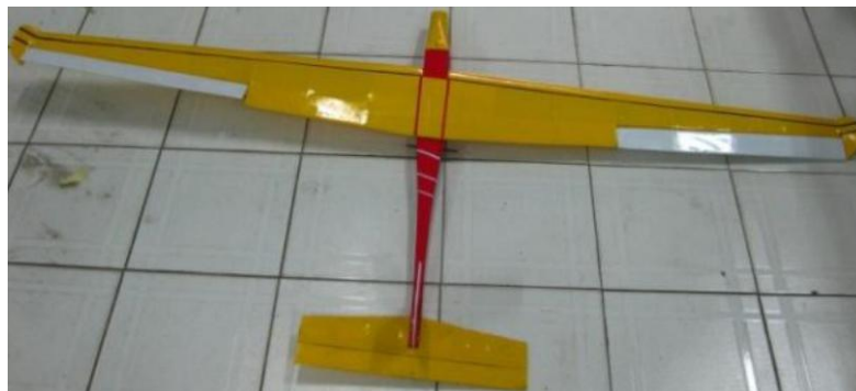
Hình 9: Mô hình máy bay lượn có sải cánh 1.8 m sau khi được chế tạo hoàn chỉnh
